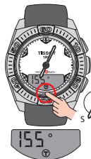
Minutová ručka ukazuje k severu, na LCD displeji se zobrazuje azimut
