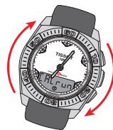
Otočte hodinkami o více než jednu úplnou otáčku horizontálně (například na stole) v místě bez magnetického rušení rychlostí otáčení cca 30° za sekundu. Celková délka trvání: max. 20 vteřin
