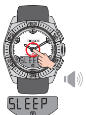
Automatické přepnutí na pohotovostní režim po 10 sekundách. Pipnutí každou sekundu
