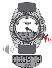
Tlačítko - k označení doběhu až 99 závodníků Poslední zaznamenaný čas doběhu bliká 10 s, zatímco celkový uplynulý čas stále běží na pozadí
