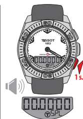
Resetování stopky mezičasu tlačítkem - Časy kol jsou uloženy až do dalšího spuštění stopky
