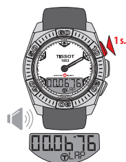
Spuštění stopky kola tlačítkem + Čas prvního kola běží
