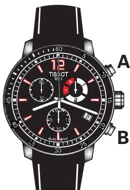
Stisknutím tlačítka **A** zastavte probíhající měření.
