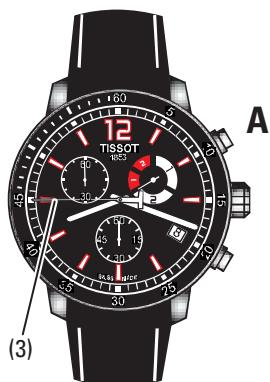
V případě prodloužení opět stiskněte tlačítko **A**, čímž se spustí měření času:
